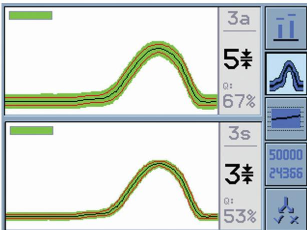
Jedes Sensorsignal wird in zwei Gerätekörpern gleichzeitig mit der Quattromatic (obere Kurve) und Systomatic Funktion (untere Kurve) überwacht
