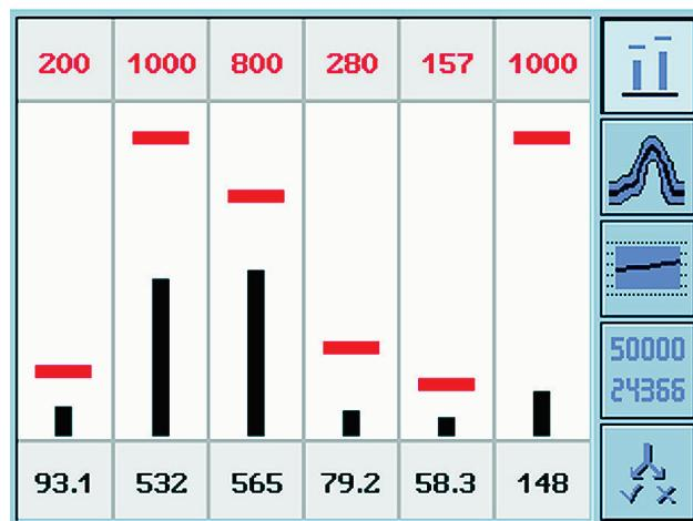
Die Balkenanzeige der Maximalkräfte zeigt bei kalibrierter Maschine das Belastungsprofil an.
