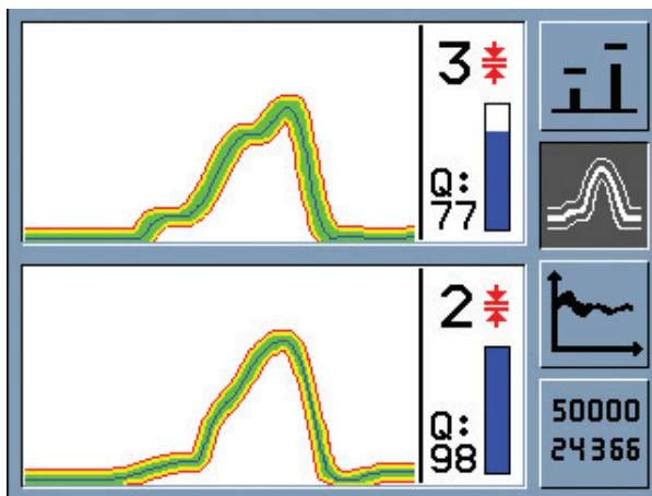
Automatische Anpassung der Überwachungsgrenzen über das Quattromatic Hüllkurvenverfahren (*optional*) und Anzeige des Qualitätsfaktors Q.
