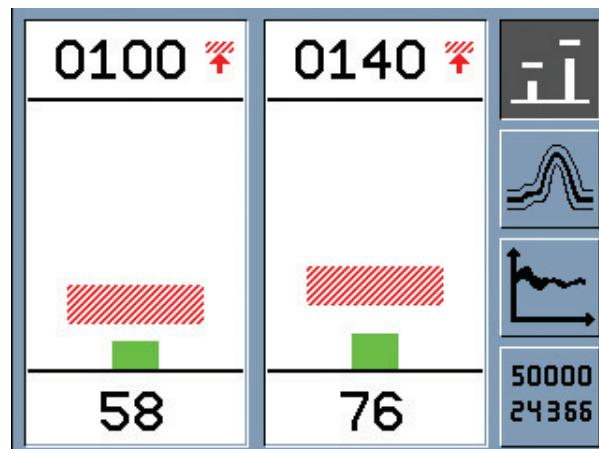
Belastungsprofil mit Anzeige der Maximalkräfte und Abschaltgrenzen.
