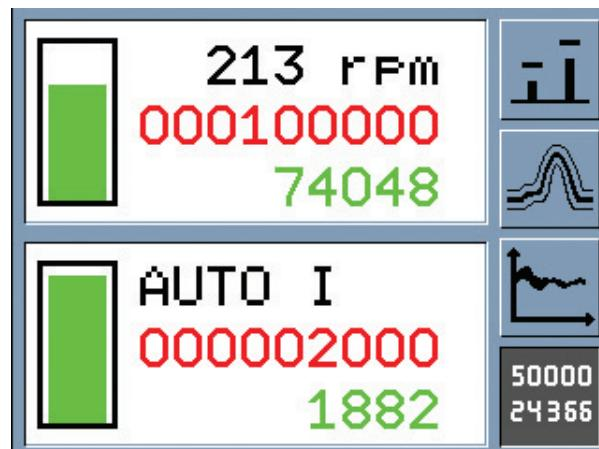
Auftrag- und Werkzeugstandmengenzähler mit Soll- und Istmenge sowie aktuelle Hubzahl.
